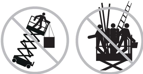
Non posizionare o fissare pesi o carichi sporgenti su nessuna parte della macchina.
