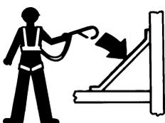
Il personale in piattaforma deve indossare una cintura o imbracatura di sicurezza in conformità alla normativa nazionale vigente. Fissare il cavo di ancoraggio di sicurezza all'attacco presente sulla piattaforma.
