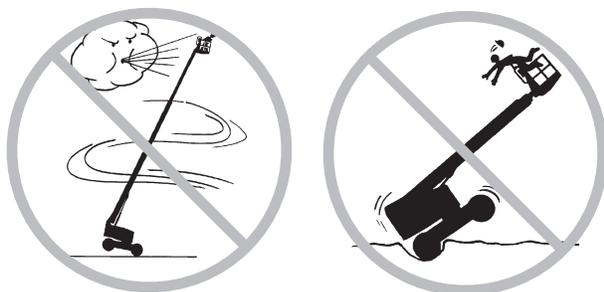
Utilizzare estrema cautela e velocità ridotta quando la macchina viene spostata con la piattaforma retratta su superfici non livellate, instabili, con detriti o scivolose, e in prossimità di fossati e dirupi.
