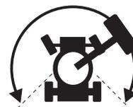
Nota: quando il sistema di abilitazione traslazione è attivo, la macchina può eseguire la traslazione nella direzione opposta rispetto alla direzione in cui viene spostata la manopola di comando traslazione e sterzata.
