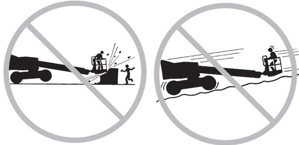
Ridurre la velocità di traslazione in base alle condizioni del suolo, alla situazione del traffico, alle pendenze, alla presenza di personale e ad altri fattori che possono essere causa di collisioni.
