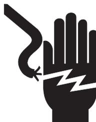
Eseguire un controllo giornaliero per rilevare eventuali cavi, cablaggi e fili danneggiati. Sostituire i componenti danneggiati prima di rimettere in funzione la macchina.
