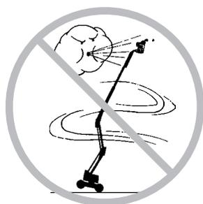
Non utilizzare la macchina in presenza di forte vento. Non aumentare la superficie o il carico della piattaforma. L'aumento della superficie esposta al vento diminuisce la stabilità della macchina.
