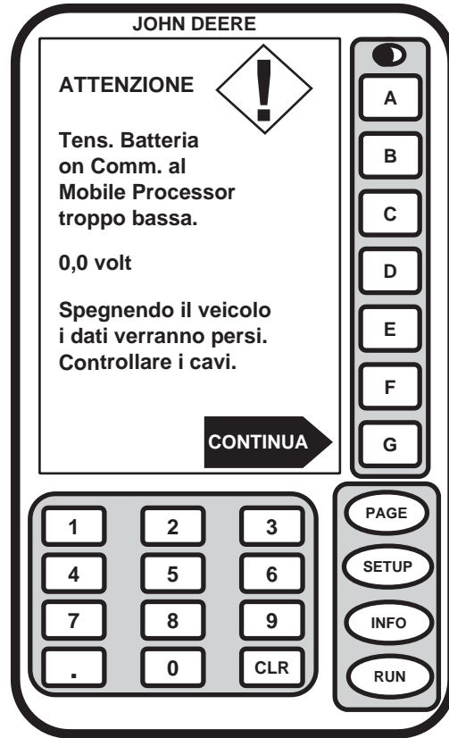
F-Tensione batteria insufficiente
