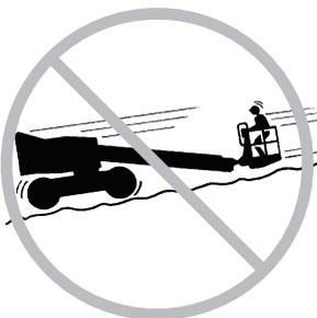
Non utilizzare un braccio sulla stessa linea di azione di una gru se i comandi della gru non sono stati prima bloccati e/o non sono state adottate le precauzioni necessarie a prevenire qualsiasi potenziale collisione.
