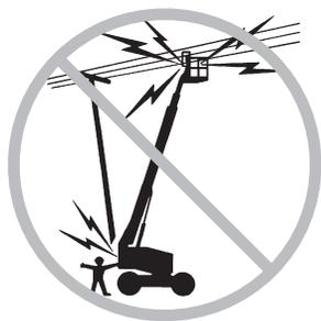
Prendere in considerazione il campo di azione della piattaforma, la possibilità di oscillazione o di abbassamento delle linee elettriche e l'azione del vento.
