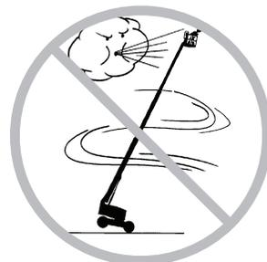
Non sollevare il braccio se la velocità del vento può superare i 12,5 m/s. Se la velocità del vento supera i 12,5 m/s quando il braccio è sollevato, abbassare il braccio e interrompere il funzionamento della macchina.
