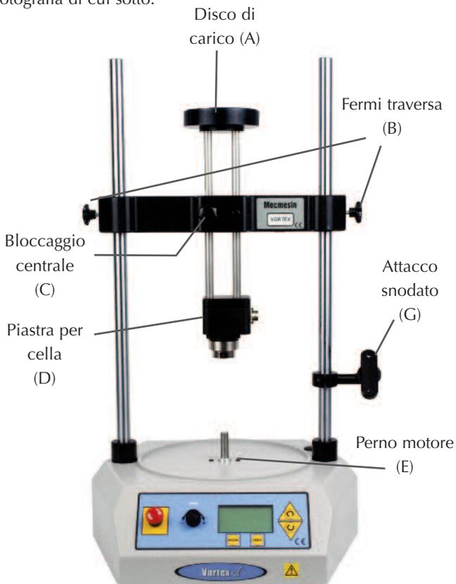
Prima di posizionare un campione nella piastra di afferraggio inferiore, occorrerà regolare l'altezza della traversa in una posizione adeguata. Usare una mano per allentare i pomoli laterali (B), mentre l'altra mano sorreggerà il peso della traversa. Posizionare la traversa nella posizione adeguata e stringere i pomoli laterali.
