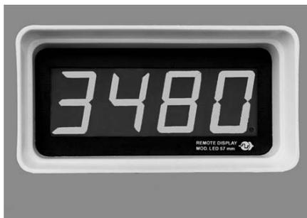
Le cifre di 57mm di altezza sono visibili sino a 25-30 metri di distanza. Incorpora un dispositivo, sensibile alla luce presente in ambiente, in grado di regolare l'intensità delle cifre visualizzate,
