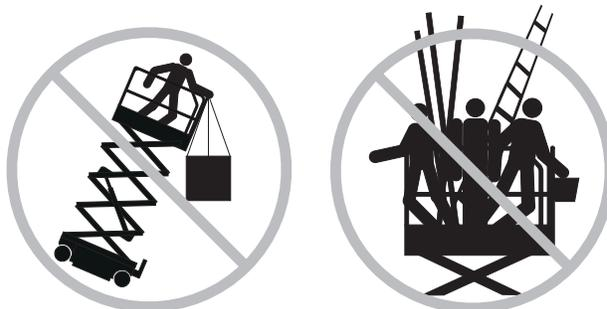
Non posizionare scale o ponteggi all'interno della piattaforma o contro qualsiasi parte della macchina.
