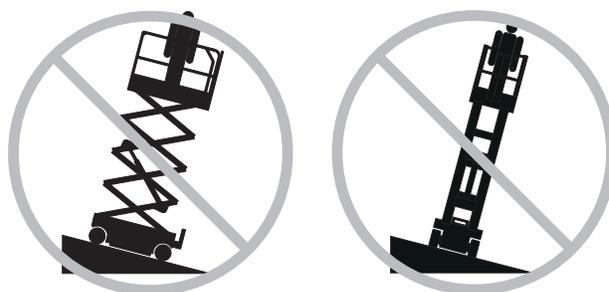
Modelli dotati di bracci estensibili della base: non abbassare i bracci estensibili della base se la macchina non è posizionata su una superficie stabile. Evitare dirupi, fossati, superfici non stabili o scivolose e altre condizioni pericolose.
