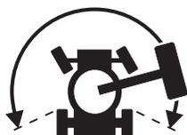
Per eseguire la traslazione, mantenere azionato l'interruttore abilitazione traslazione in una delle due posizioni laterali e spostare lentamente dal centro la manopola di comando traslazione.
