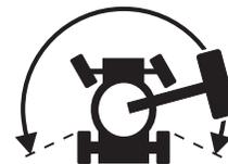
Nota: quando il sistema di abilitazione traslazione è attivo, la macchina può eseguire la traslazione nella direzione opposta rispetto alla direzione in cui viene spostata la manopola di comando traslazione e sterzata.
