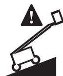
La lampada spia accesa indica che la macchina non è livellata. Quando questa spia si accende, l'allarme di inclinazione suona e sul display a cristalli liquidi del quadro comandi in piattaforma viene visualizzato il messaggio MACHINE IS NOT LEVEL (MACCHINA NON LIVELLATA).
