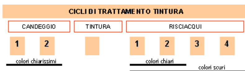
Figura 22:sequenza standard dei lavaggi in un ciclo di tintura
