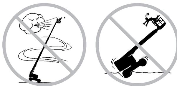
Utilizzare estrema cautela e velocità ridotta quando la macchina viene spostata con la piattaforma retratta su superfici non livellate, instabili, con detriti o scivolose, e in prossimità di fossati e dirupi.
