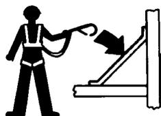
Il personale in piattaforma deve indossare una cintura o imbracatura di sicurezza in conformità alla normativa nazionale vigente. Fissare la corda di ancoraggio di sicurezza all'attacco presente sulla piattaforma.
