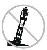
Non utilizzare l'allarme di inclinazione come indicatore di livello. L'allarme di inclinazione suona solo quando la macchina si trova su una pendenza.
