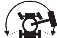
Nota: quando il sistema di abilitazione traslazione è attivo, la macchina può eseguire la traslazione nella direzione opposta rispetto alla direzione in cui viene spostata la manopola di comando traslazione e sterzata.
