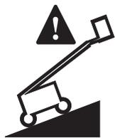
Se l'allarme di inclinazione suona quando la piattaforma è sollevata, l'indicatore della macchina non livellata si accende e la funzione di traslazione in una o in entrambe le direzioni non sarà operativa. Stabilire la posizione del braccio rispetto al pendio come indicato di seguito. Seguire la procedura per abbassare il braccio prima di spostare la macchina su una superficie stabile e livellata. Non ruotare il braccio durante l'abbassamento.
