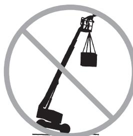
Non posizionare o fissare pesi o carichi sporgenti su nessuna parte della macchina.
