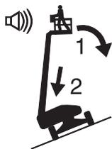
Se l'allarme di inclinazione suona quando la piattaforma è orientata verso la parte ascendente della pendenza:
