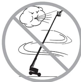
Non sollevare il braccio se la velocità del vento può superare i 12,5 m/s. Se la velocità del vento supera i 12,5 m/s quando il braccio è sollevato, abbassare il braccio e interrompere l'utilizzo della macchina.
