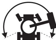
Per eseguire la traslazione, mantenere azionato l'interruttore di abilitazione traslazione in una delle due posizioni laterali e spostare lentamente dal centro la manopola di comando traslazione.
