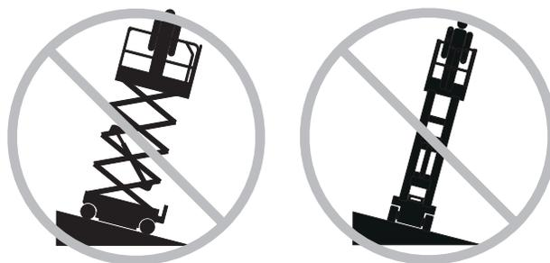
Non utilizzare l'allarme di inclinazione come indicatore di livello. L'allarme inclinazione suona sullo chassis e in piattaforma se la macchina si trova in forte pendenza.
