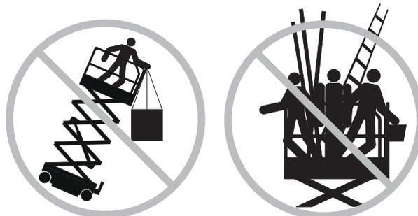
Non posizionare scale o ponteggi all'interno della piattaforma o contro qualsiasi parte della macchina.
