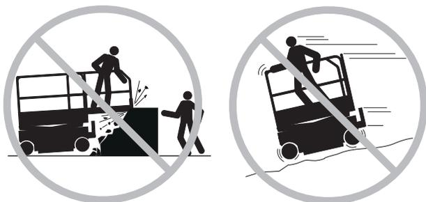
Ridurre la velocità di traslazione in base alle condizioni del suolo, alla situazione del traffico, alle pendenze, alla presenza di personale e ad altri fattori che potrebbero essere causa di collisioni.
