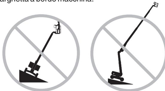
Non utilizzare l'allarme di inclinazione come indicatore di livello. L'allarme di inclinazione suona in piattaforma solo quando la macchina si trova su una forte pendenza.
