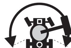
Nota: se il sistema di abilitazione traslazione è in uso, la macchina può eseguire la traslazione nella direzione opposta rispetto alla direzione in cui viene spostata la manopola di comando traslazione e sterzata.
