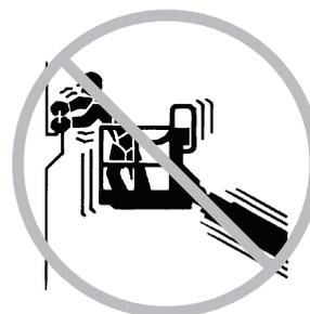
Accertarsi che il terreno sia in grado di sostenere il peso della macchina indicato nelle specifiche tecniche del manuale. È vietato l'utilizzo della macchina su terreni fangosi, ghiacciati, sdruciolevoli, sconnessi o con buche.
