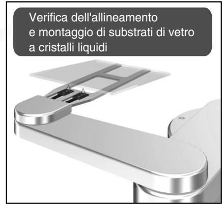
Verifica dell'allineamento e montaggio di substrati di vetro a cristalli liquidi
