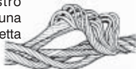
Deformazione a canestro (nido) (fune antigiratoria) causata da gole usurate delle pulegge
