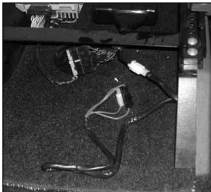
comando. Chiudere tutte le porte e rimuovere la chiave dal blocchetto di avviamento. Sotto il sedile del passeggero localizzate la centralina chiusura centralizzata & immobilizer con il suo cablaggio ed il connettore bianco a 4 poli con il cablaggio formato da 2 cavi neri ad esso collegato.
