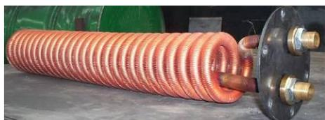
Se l'impianto di riscaldamento, lavora con una temperatura dell'acqua in caldaia di 70÷80 °C e la temperatura dell'acqua fredda in ingresso è 10°C, la serpentina può garantire un incremento di temperatura di circa 30÷35 °C per una portata di acqua di 10÷12 litri al minuto. Se
