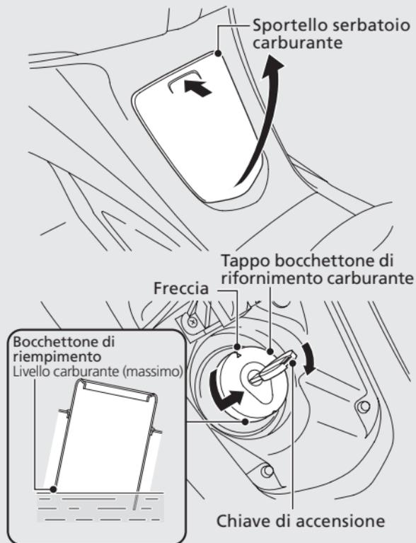
Non rifornire di carburante oltre il bocchettone di riempimento.
