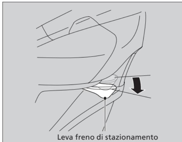
Appoggiare lo scooter su una superficie solida e in piano. Spegnerne il motore e spingere lo scooter mentre si aziona la leva del freno di stazionamento per verificare l'efficacia del freno di stazionamento.
