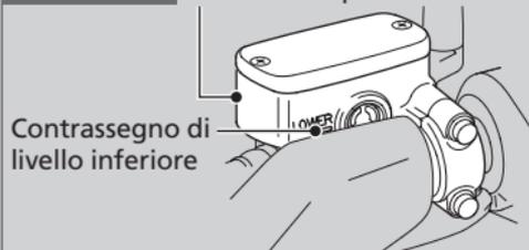
Lato posteriore Serbatoio liquido freno posteriore
