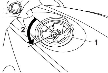
1. Coperchietto della serratura del serbatoio carburante
