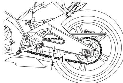
1. Tensione della catena di trasmissione
