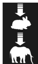
Regolazione della velocità nella leva di comando: nella prima posizione, circa a metà corsa, lo spaccalegna è più veloce ma meno potente, premendo a fondo la leva, la macchina rallenta ma spacca il legno a piena potenza.
