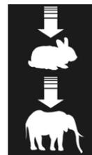
Regeling van de snelheid door middel van de bedieningshendel: in de eerste stand, ongeveer halverwege de slag, werkt de machine sneller, maar levert de machine minder vermogen, als u de hendel doordrukt totdat hij niet meer verder kan, dan werkt de machine langzamer, maar klooft de machine het hout op vol vermogen.
