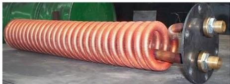
Se l'impianto di riscaldamento lavora con una temperatura dell'acqua in caldaia di 70÷80 °C e la temperatura dell'acqua fredda in ingresso è 10°C, la serpentina può garantire un incremento di temperatura di circa 30÷35 °C per una portata di acqua di 10÷12 litri al minuto. Se la temperatura dell'acqua in caldaia è inferiore, sarà inferiore anche l'incremento di temperatura.
