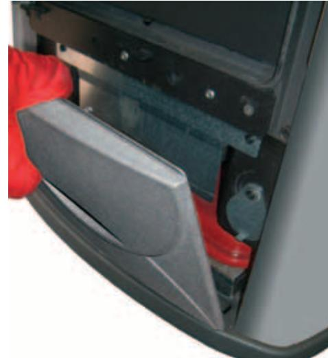
CERRAR las aperturas de los conductos y recolocar la parte frontal, fijando en la izquierda la pequeña palanca
