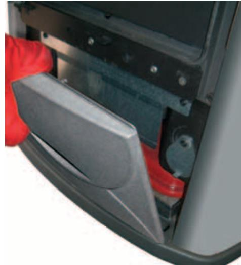
FERMER les fentes des conduits et remettre en place l'élément frontal en fixant à gauche le levier
