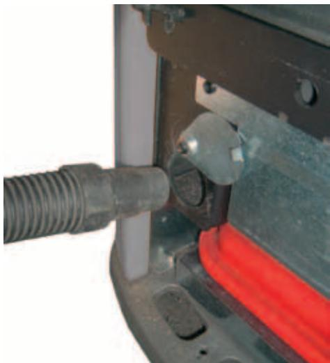
Aspirar los conductos utilizando un aspirador idóneo o mejor aún nuestro CUBO ASPIRA-CENIZAS
