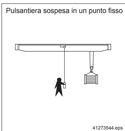
Il comando da posizione fissa è utilizzato quando il percorso di lavoro, o di trasporto del carico, è parallelo alla via di corsa del carro ponte. In questo caso una diretta guida del carico da parte dell'operatore non è sempre possibile.
