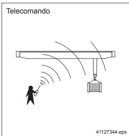
Con l'uso del telecomando l'operatore ha piena libertà di movimento in senso longitudinale e trasversale, indipendentemente dalla posizione del carro ponte. Questo tipo di comando è idoneo per velocità di traslazione fino a ca. 80 m/min (nel perimetro di applicazione della Repubblica Federale di Germania).
