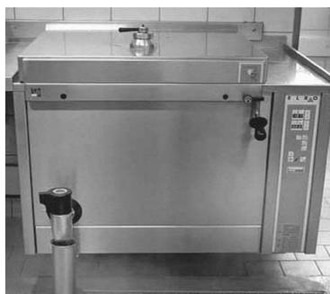
Un sistema pratico di protezione per prevenire brutte scottature, quando si usa un forno a vapore è quello di utilizzare lo sportello come protezione. Il personale dovrà aprire il forno a vapore, stando dietro allo sportello, in modo da fare uscire tutto il vapore.
