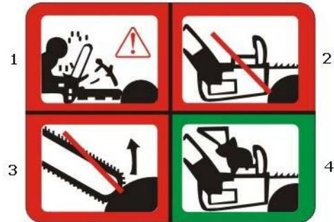
**ATTENZIONE:** il contraccolpo può portare ad una pericolosa perdita del controllo della motosega elettrica causando lesioni molto gravi o fatali all'operatore o a qualsiasi persona che sia nelle vicinanze. Fare sempre molta attenzione quando si maneggia l'elettrotensile in quanto il contraccolpo da rotazione e da stretta sono le maggiori cause di incidenti.
