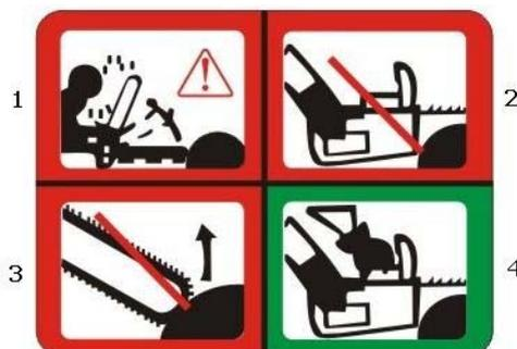
**POZOR:** protisunek lahko privede do nevarne izgube nadzora nad električno motorno žago in posledične poškodbe ali smrti uporabnika ali ljudi v bližini. Pri uporabi električnega orodja bodite vedno zelo previdni, saj so rotacijski in blokadni protisunki glavni povzročitelji nesreč.
