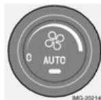
La funzione AUTO regola automaticamente il climatizzatore in modo da raggiungere la temperatura selezionata. La funzione automatica controlla il riscaldamento, la climatizzazione, la velocità della ventola, il ricircolo e la distribuzione dell'aria. Selezionando una o più funzioni manuali, le altre funzioni continuano a essere controllate automaticamente. Tutte le impostazioni manuali vengono disinserite quando si attiva AUTO. Il display mostra CLIMA AUTOM.
