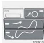
Premendo i pulsanti di distribuzione dell'aria, si può scegliere di orientare il flusso dell'aria verso finestrini, abitacolo e pavimento.
