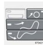
Premendo i pulsanti di distribuzione dell'aria, si può scegliere di orientare il flusso dell'aria verso finestrini, abitacolo e pavimento.
