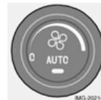
Regolare la velocità della ventola ruotando il pomello. La velocità della ventola si regola automaticamente se è selezionato AUTO. La velocità della ventola impostata in precedenza si disattiva.
