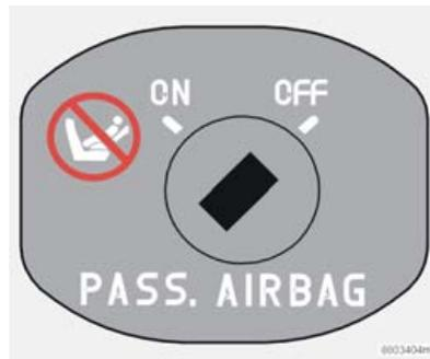
*Commutatore SRS in posizione OFF.*
