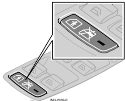
*Bloccaggio degli alzacristalli elettrici posteriori e fermo di sicurezza elettrico per bambini<sup>1</sup>.*
