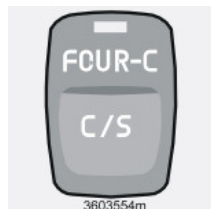
Interruttore FOUR-C nel quadro centrale
