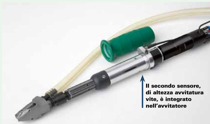
Il secondo sensore, di altezza avvitatura vite, è integrato nell'avvitatore
