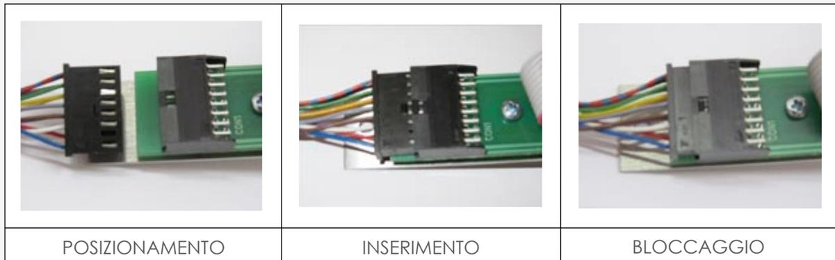
L'unità di elettroblocco in versione da appoggio risulta equipaggiata con un connettore maschio verticale a circuito stampato 16 poli, inserirvi il connettore femmina 16 poli posto ad una delle due estremità del cablaggio, rispettandone la corretta polarizzazione obbligata dalla chiave di inserimento. Inserire il connettore sino a fine corsa garantendo l'impegno dell'aggancio meccanico.
