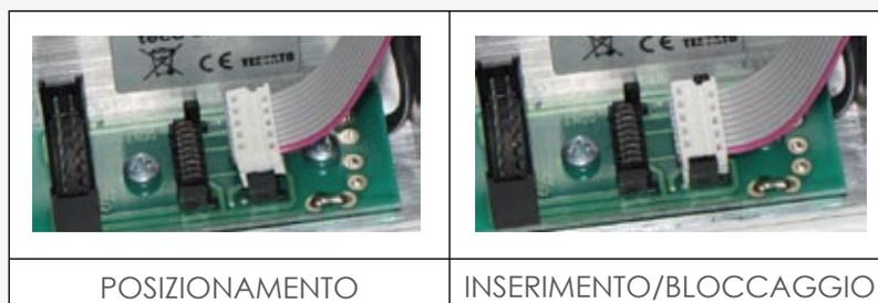
La connessione lato Unità di Elettroblocco della seconda Unità di Comando avviene tramite l'inserimento del connettore femmina posizionato sull'estremità del cablaggio nel corrispondente connettore maschio 10 poli integrato sul circuito stampato dell'Unità di Elettroblocco. Posizionare il connettore femmina sopra al connettore maschio rispettando la sua polarizzazione e spingere il connettore femmina fino al suo completo inserimento.
