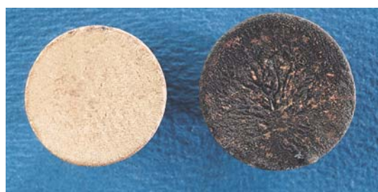
In questa illustrazione è evidente la differenza di risultato che si ottiene fondendo la stessa lega in atmosfera naturale ed eseguendo il completo ciclo di fusione in atmosfera inerte.
