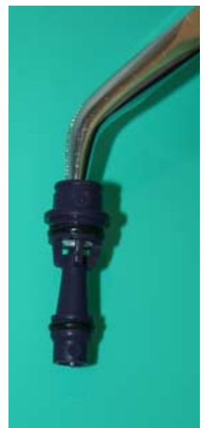
2 - Sfilare l'eiettore con l'aiuto di una pinza
