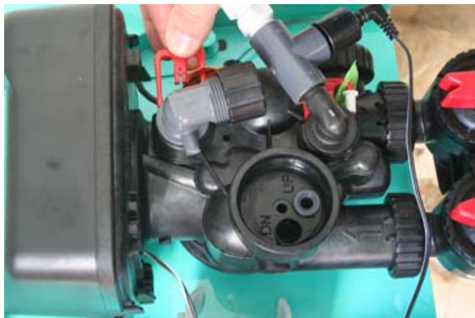
1 - Togliere la fascietta di fissaggio
