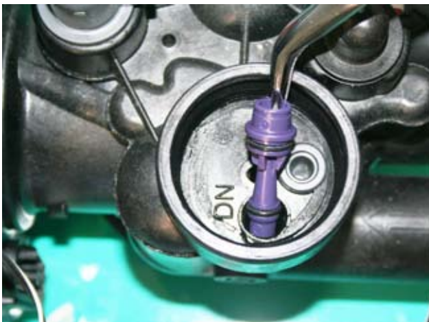
3 - Sfilato l'eiettore, in caso di sostituzione vedi TABELLA EIETTORE pagina 10. Per la pulizia, procedere come in figura 4.
