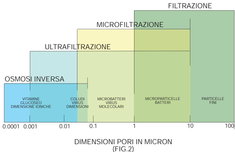
Pur avendo dimensioni dei pori minima, l'osmosi inversa non opera una filtrazione convenzionale, ma piuttosto una "filtrazione tangenziale".
