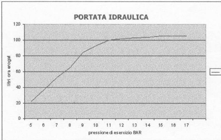
La porta idraulica è stata fatta da una sperimentazione effettuata su di un'acqua avente una salinità media di 500mg/l di TDS, acqua che rappresenta la qualità di tipo erogata da acquedotto.
