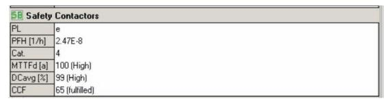
Si noti che tra i dati del pulsante di emergenza, del contattore 100S e del relè 700HPS figurano MTTFd, DCavg e CCF, poiché si tratta di dispositivi elettromeccanici. Durante le valutazioni della sicurezza funzionale dei dispositivi elettromeccanici, infatti, occorre tenere presente la frequenza di azionamento, verificare se il monitoraggio è efficace per rilevare i guasti e se le specifiche e l'installazione sono corrette.
