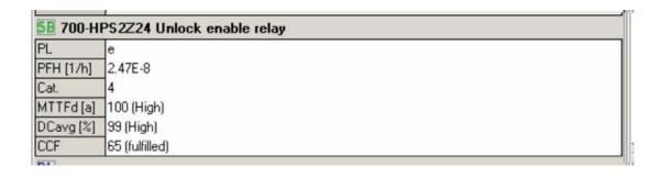
La funzione di sicurezza di arresto di emergenza del moto pericoloso azionata tramite pulsante di emergenza può essere modellata come rappresentato di seguito.
