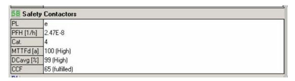
Di seguito sono riportati i dati di sicurezza funzionale per il sottosistema di uscita del relè 700HPS:
