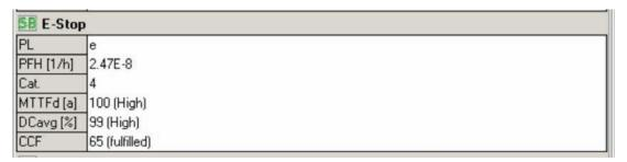
Di seguito sono riportati i dati di sicurezza funzionale per il sottosistema logico del relè GSR DI:
