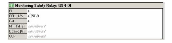
Di seguito sono riportati i dati di sicurezza funzionale per il sottosistema logico del relè EMD:
