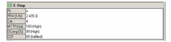
Di seguito sono riportati i dati di sicurezza funzionale per il sottosistema logico del relè GSR DI:
