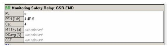
Di seguito sono riportati i dati di sicurezza funzionale per il sottosistema di uscita del contattore 100S:
