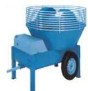
apertura mediante uso di chiave o attrezzo e sono provvisti di contatto elettrico di sicurezza (interblocco). Gli elementi mobili che realizzano la lavorazioni delle malte (albero di trasmissione, macine, raschiatori, ecc. ) sono circondate da un riparo atto ad evitare possibile offese all'incolumità degli operatori.
