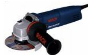
smerigliatrici hanno potenza maggiore, velocità minore ma montano dischi di diametro da 180 mm a 230 mm).
