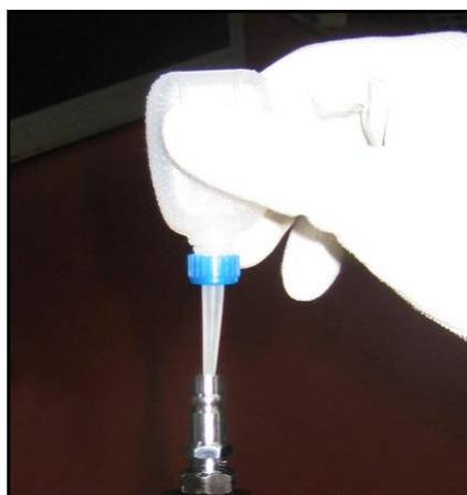
Figura 9 – Lubrificazione dell'ugello.
