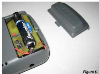
6) RICHIUDERE I DUE GUSCI DEL RADIOCOMANDO FISSANDO LE TRE VITI E RICHIUDERE IL VANO PILE CON L'APPOSITO COPERCHIO IN DOTAZIONE CON IL KIT
