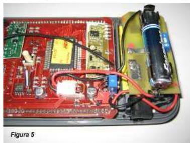
5) POSIZIONARE IL NUOVO KIT SUL VANO PILE DEL RADIOCOMANDO COLLEGANDO IL CONNETTORE
