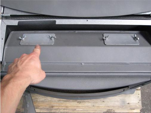
**TOGLIERE LAMA SUPERIORE E APRIRE LE DUE ISPEZIONI SUPERIORI DELLA MACCHINA PER SPAZZOLARE LA SCHIENA DELLA CAMERA DI COMBUSTIONE**
