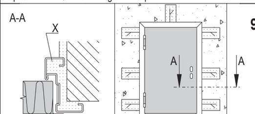
Fissare le zanche con malta a presa rapida. Riempire il vuoto tra il telaio e la parete con malta cementizia (dettaglio X), evitando imbarcamenti.
