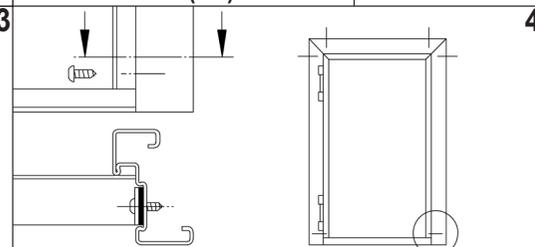
Senza togliere la guarnizione, svitare le viti in basso ai due montanti e riavvitare inserendo il distanziale. Le porte multiuso non sono dotate di guarnizioni termosopendenti, né di regolatore di chiusura.
