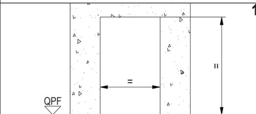
Sballare il telaio e controllare che il foro muro corrisponda alla misura d'ordinazione FM della porta, riportata nell'etichetta applicata sul telaio. Stabilire la definitiva quota del pavimento finito (QPF).
