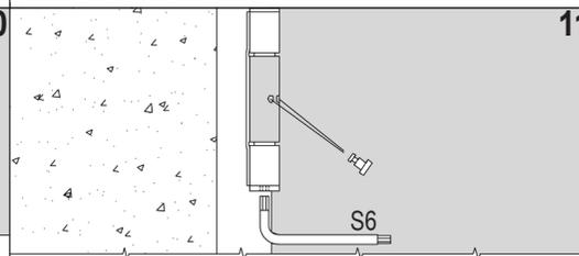
Caricare la cerniera a molla nel senso dell'apertura e infilare il nottolino d'arresto. Anche in combinazione con chiudiporta caricare comunque leggermente la molla ed infilare il nottolino.
