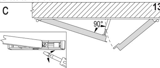
Seguire la stessa procedura di posa per porte a due ante, aggiungendo: a) caricare 2 spinotti a molla; b) tassellare la bocca a pavimento; c) se presente, registrare il regolatore di chiusura RC/STD (appoggio a 90° contro l'anta principale).
