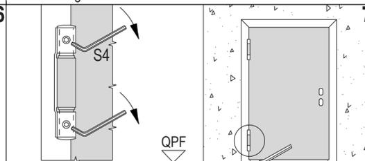
Portare a contatto le sfere della cerniera portante agendo sui grani filettati. Operazione da eseguire con la massima attenzione aiutandosi con una leva.
