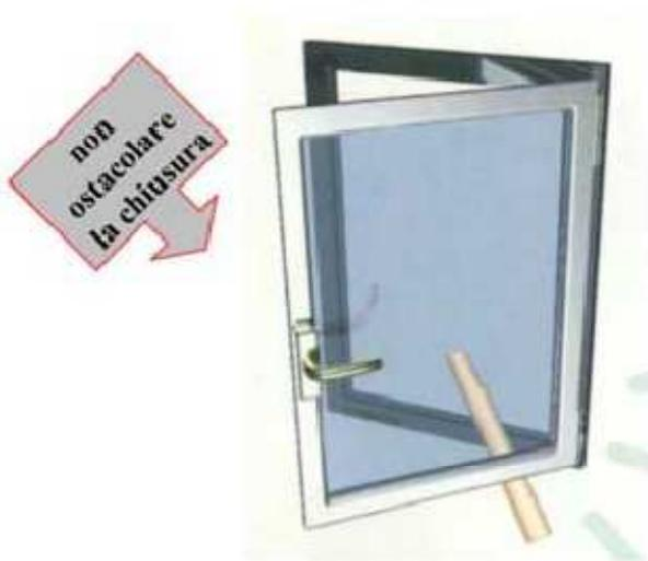
Non chiudere l'infisso con la maniglia in posizione di chiusura: l'urto con la ferramenta potrebbe danneggiare l'infisso.
