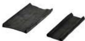
Interposto tra muri e tavolato è prevista una guarnizione in EPDM elastico da 80 mm o 45 mm, piatta con due rialzi da 10 mm sui due lati per garantire la tenuta all'aria, al vento e al vapore.
