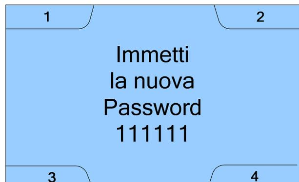
Attenzione: in questa schermata non c'è un comando di "Annulla" o un tempo di timeout che permette di tornare alla condizione precedente. Nell'indecisione, se si entra in questa sezione per errore, inserire il codice di fabbrica: **111111**.
