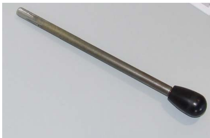
Fig. 5.2 Leva di caricamento molle VCB
