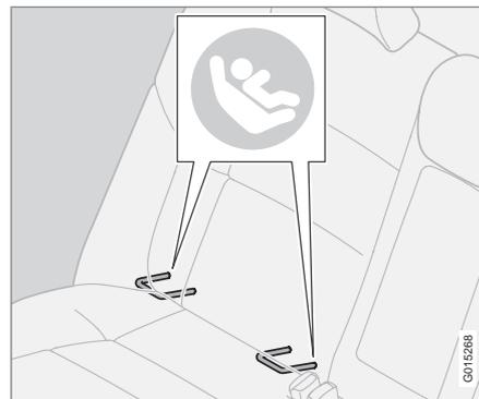
Gli attacchi per il sistema di fissaggio ISOFIX sono nascosti dietro la parte inferiore dello
