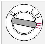
Il motorino di avviamento si inserisce. La chiave telecomando viene rilasciata e ritorna automaticamente in posizione di marcia all'accensione del motore.
