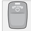
Se l'automobile è dotata di fari attivi (ABL, Active Bending Lights), la luce dei fari segue i movimenti del volante durante la guida. La funzione si attiva automaticamente all'accensione dell'automobile e può essere disattivata/attivata premendo il pulsante. La spia sul pulsante è accesa quando la funzione è attivata
