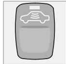
Questo pulsante si utilizza per escludere il bloccaporte (per bloccaporte si intende la posizione in cui le portiere non possono essere aperte dall'interno quando sono bloccate). Questo pulsante si utilizza anche per disattivare i sensori di movimento e inclinazione dell'anti-furto\*. La spia si accende quando le funzioni sono escluse/disattivate, vedere pagine 124 e 128.
