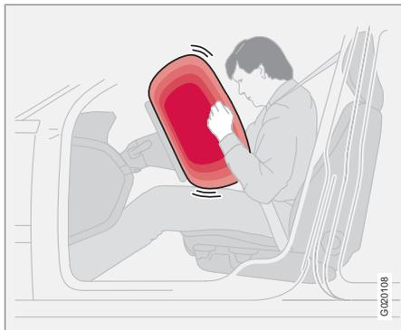
Oltre alla cintura di sicurezza, l'automobile dispone di un airbag SRS (sistema di ritenuta supplementare) sul lato conducente. L'airbag è ripiegato al centro del volante. Il volante è contrassegnato con **SRS AIRBAG**.
