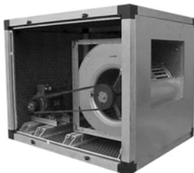
Ventilatore centrifugo cassonato a doppia aspirazione con pale in avanti, motore accoppiato alla girante tramite cinghia i pulegge.
