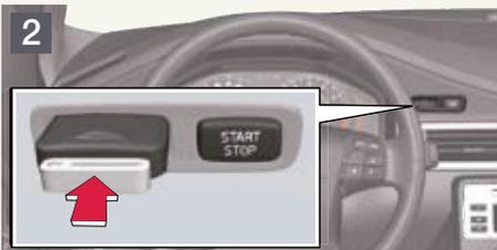
**Premere il telecomando.** Il telecomando viene espulso. Il cambio automatico deve essere in posizione P.
