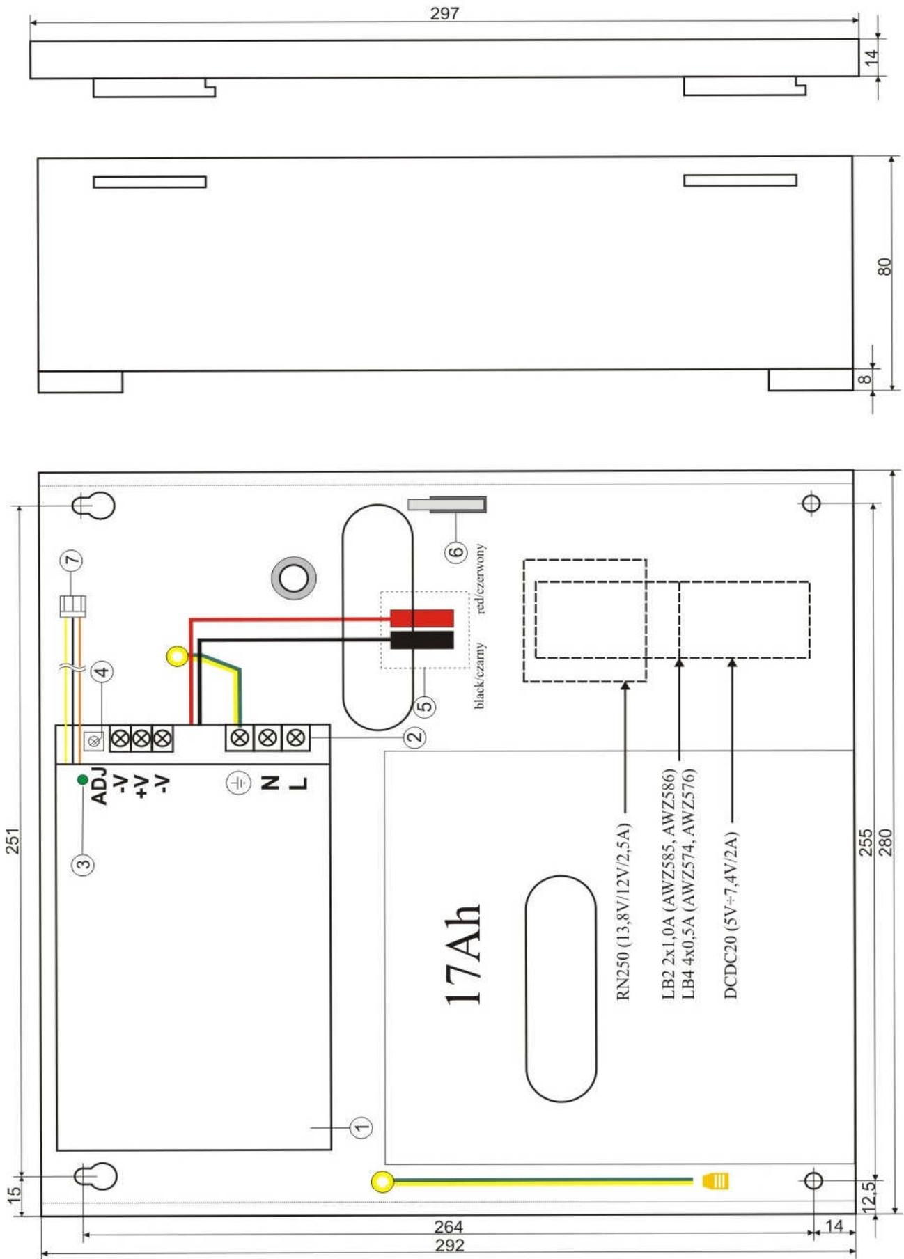
Fig.2. Vista dell'alimentatore.
