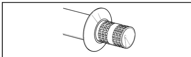
**Kit verticale con tegola in alluminio Ø 80/125.** Montaggio kit: installare la flangia concentrica (2) sul foro più interno della caldaia interponendo la guarnizione (1) e serrare con le viti presenti nel kit. Innestare l'adattatore (3) con lato maschio (liscio) nel lato femmina della flangia concentrica (2). Installazione della finta tegola in alluminio. Sostituire alle tegole la lastra in alluminio (5), sagomandola in modo da fare defluire l'acqua piovana. Posizionare sulla tegola in
