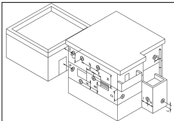
**Scarico dei prodotti della combustione di apparecchi a tiraggio forzato entro spazi chiusi a cielo libero.** Negli spazi a cielo libero chiusi su tutti i lati (pozzi di ventilazione, cavedi, cortili e simili), è consentito lo scarico diretto dei prodotti della combustione di apparecchi a gas a tiraggio naturale o forzato e portata termica oltre 4 e fino a 35 kW, purché siano rispettate le condizioni di cui alla normativa tecnica vigente (UNI 7129 par. 4.7).
