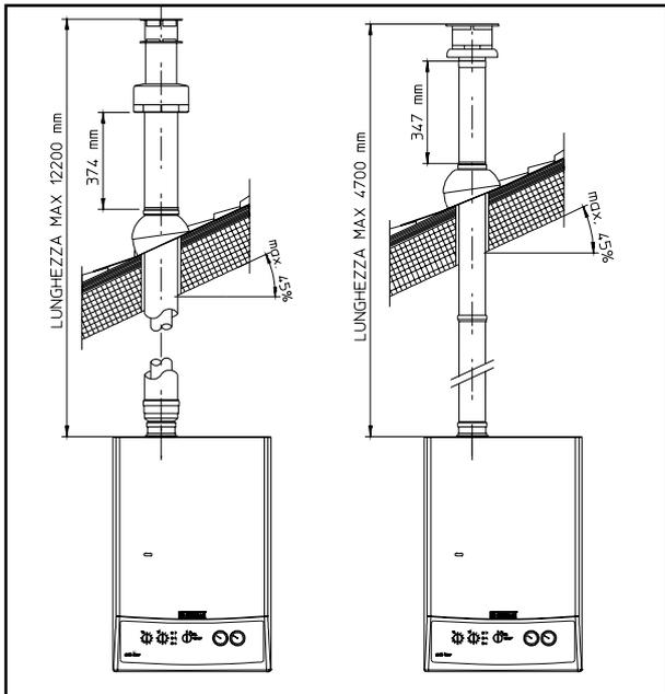
**Kit separatore Ø 80/80.** Il kit separatore Ø 80/80, consente di separare i condotti di scarico fumi e aspirazione aria secondo lo schema riportato in figura. Dal condotto (A) vengono espulsi i prodotti della combustione. Dal condotto (B) viene aspirata l'aria necessaria per la combustione. Entrambi i condotti possono essere orientati in qualsiasi direzione.
