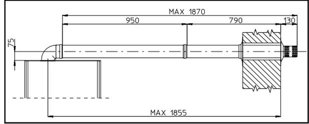
Collegamento con N°1 prolunga. Distanza fra asse verticale caldaia e parete esterna mm 1855.
