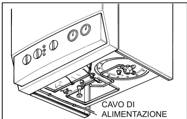
**Allacciamento elettrico termostato ambiente On/Off.** L'eventuale termostato o cronotermostato ambiente On/Off va collegato ai morsetti 34 e 35 eliminando il ponte P1. Esso deve avere un isolamento elettrico esclusivamente di classe II (norma EN 60335-1) vedi schema elettrico pag. 22. Il contatto dell'eventuale termostato ambiente, ad allacciamento avvenuto, lavora a tensione di rete e deve essere in grado di commutare una corrente minima di 0,8A.
