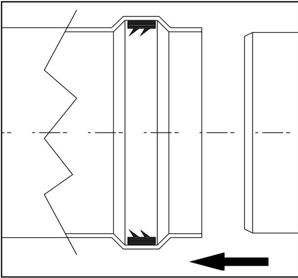
**Installazione diaframma.** Per un corretto funzionamento della caldaia è necessario installare sull'uscita della camera stagna e prima del condotto di aspirazione e scarico un diaframma (vedi figura). La scelta del diaframma appropriato avviene in base al tipo di condotto e alla sua massima estensione: detto calcolo si può effettuare con l'utilizzo delle seguenti tabelle:
