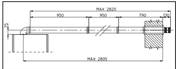
Collegamento con N°2 prolunghe. Distanza fra asse verticale caldaia e parete esterna mm 2805.
