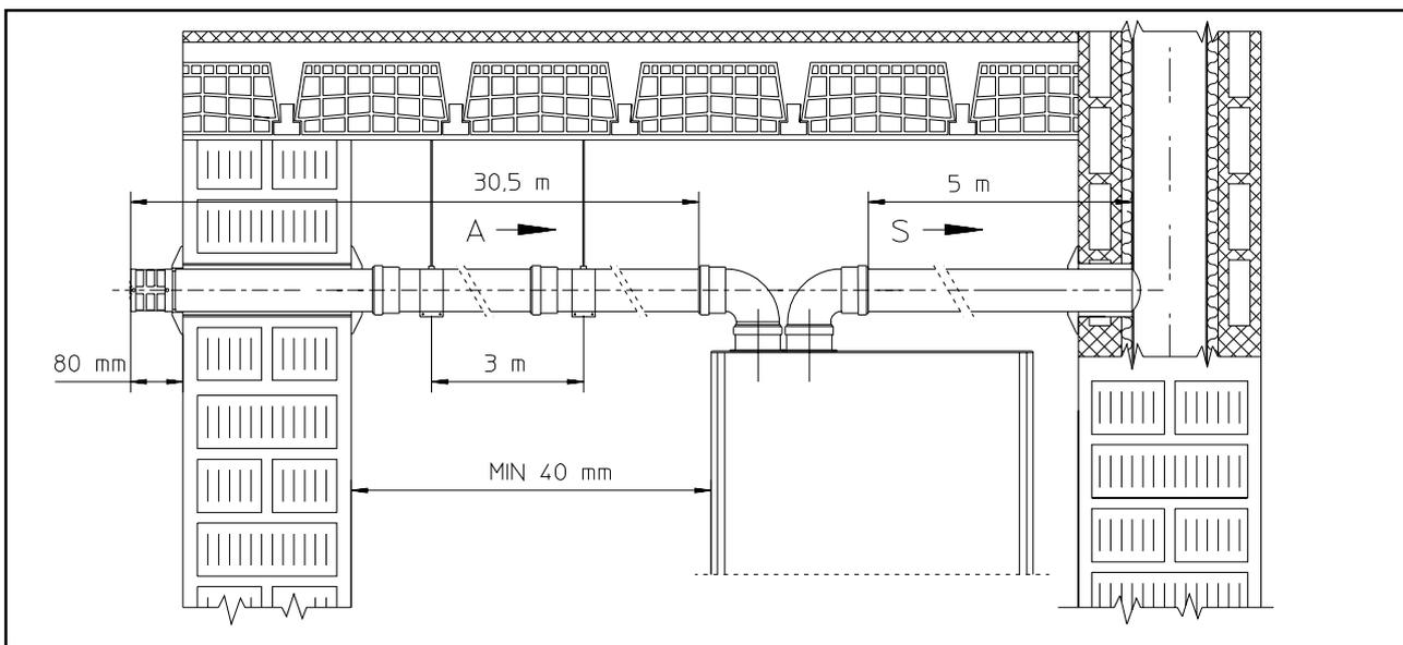
**N.B.:** durante l'installazione dei condotti  $\varnothing 80$  è necessario installare ogni 3 metri una fascetta rompitratta con tassello.
